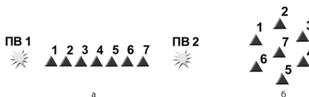
Рис. 8. Схема наблюдений по методике САПВ в активном (а) и пассивном (б) режимах
