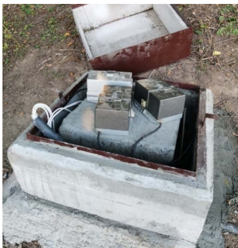
Рис. 3. Сейсмические датчики на выносном постаменте
