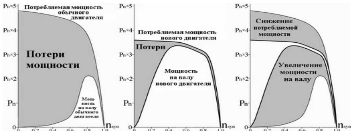
Рис. 4. Характеристики асинхронного двигателя с реконструированной обмоткой ротора
