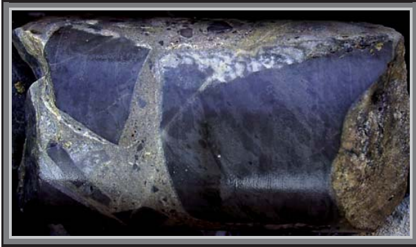
Керн скважины. Полигенная брекчия. Обломки аргиллитов и алевролитов олистостромы рассечены гидротермальными карбонат-барит-кварцевыми прожилками с брекчиевой текстурой. В прожилках – тонкая обильная вкрапленность сульфидов
