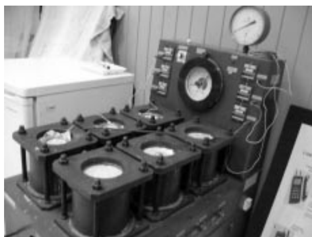
Рис. 2. Установка для определения марки бетона по водонепроницаемости по «мокрому пятну».
