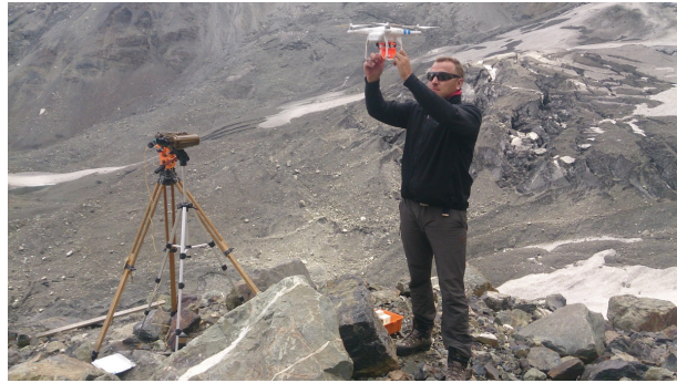
Рис. 1. Малый квадрокоптер DJI Phantom с установленной камерой для съемки
