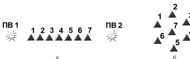
Рис. 8. Схема наблюдений по методике САПМ в активном (а) и пассивном (б) режимах
