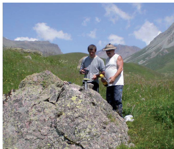
Фото 2. Пункт GPS-наблюдений «Эрман». Установка GPS-оборудования
