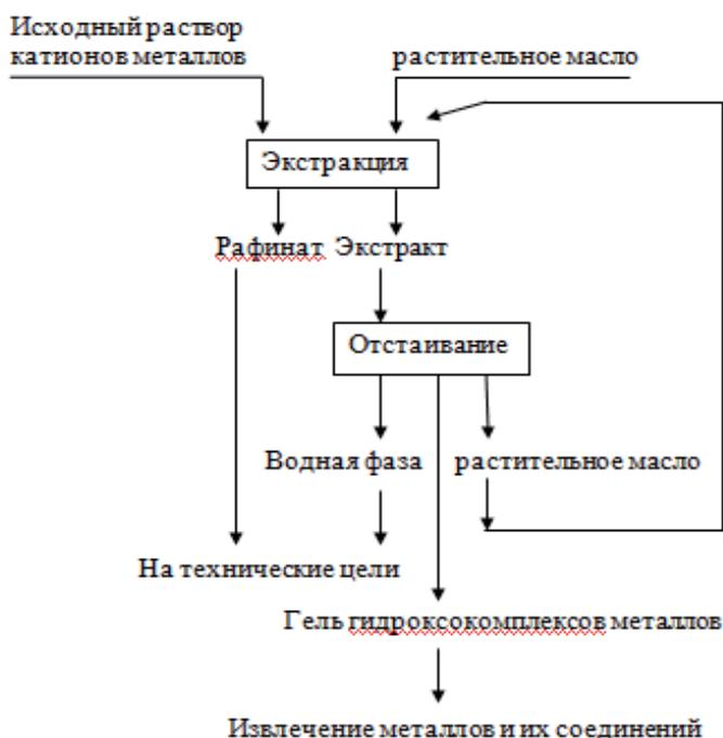
Рис. 7. Схема экстракции ионов металлов растительными маслами
