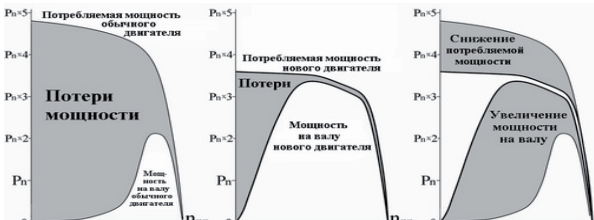
Рис. Сравнительные характеристики обычного асинхронного и модернизированного электродвигателей: потребляемой мощности; потерь мощности; мощности на валу
