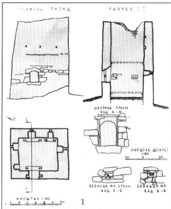
Рис. 2. 1 – Фасад, план и разрез боевой башни в с. Дзизвгис.
