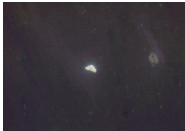
Рис. 5. Лапчатое выделение белого изотропного рудного минерала в окварцованных дацитах КРМС Кюкюрютлю (обр. 105/99). Ширина поля зрения 0,9 мм
